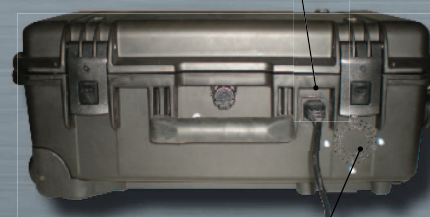
Ventilador (salida de aire)
